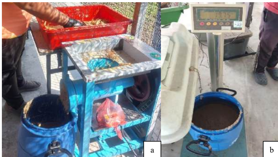
Rajah 5: (a) Sisa makanan dimasukkan dalam mesin pengisar sebelum dhancurkan menjadi substrat yang bersaiz lebih halus (b) Sisa makanan yang telah dihancurkan, ditimbang sebelum diletakkan dalam plot-plot penternakan sebagai substrat larva LAH
